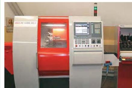
CNC steht als Abkürzung für „Computerized Numerical Control“ (engl.) und bedeutet sinngemäß soviel wie „computerisierte numerische Steuerung“. Eine CNC-gesteuerte Drehbank ist also eine Drehbank, deren Arbeitsschritte nicht von Hand getätigt werden, sondern über einen Computer gesteuert
